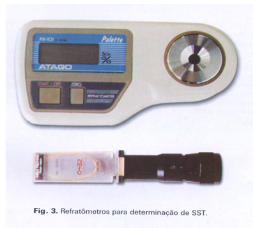
Figura 95 – Refratômetros utilizados para a determinação do teor de sólidos solúveis totais (SST) das frutas. Foto: José Carlos Fachinello
