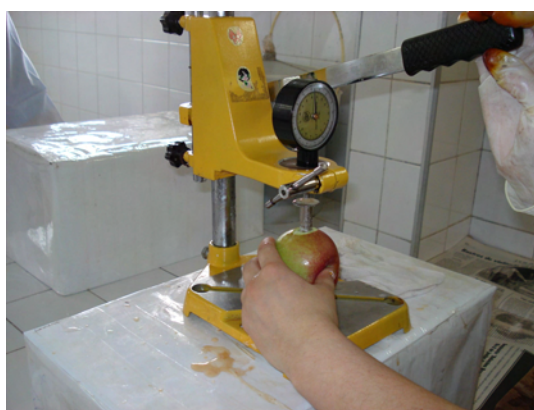
Figura 94 – Penetrômetro utilizado para medir a firmeza da polpa das frutas. Foto: José Carlos Fachinello
